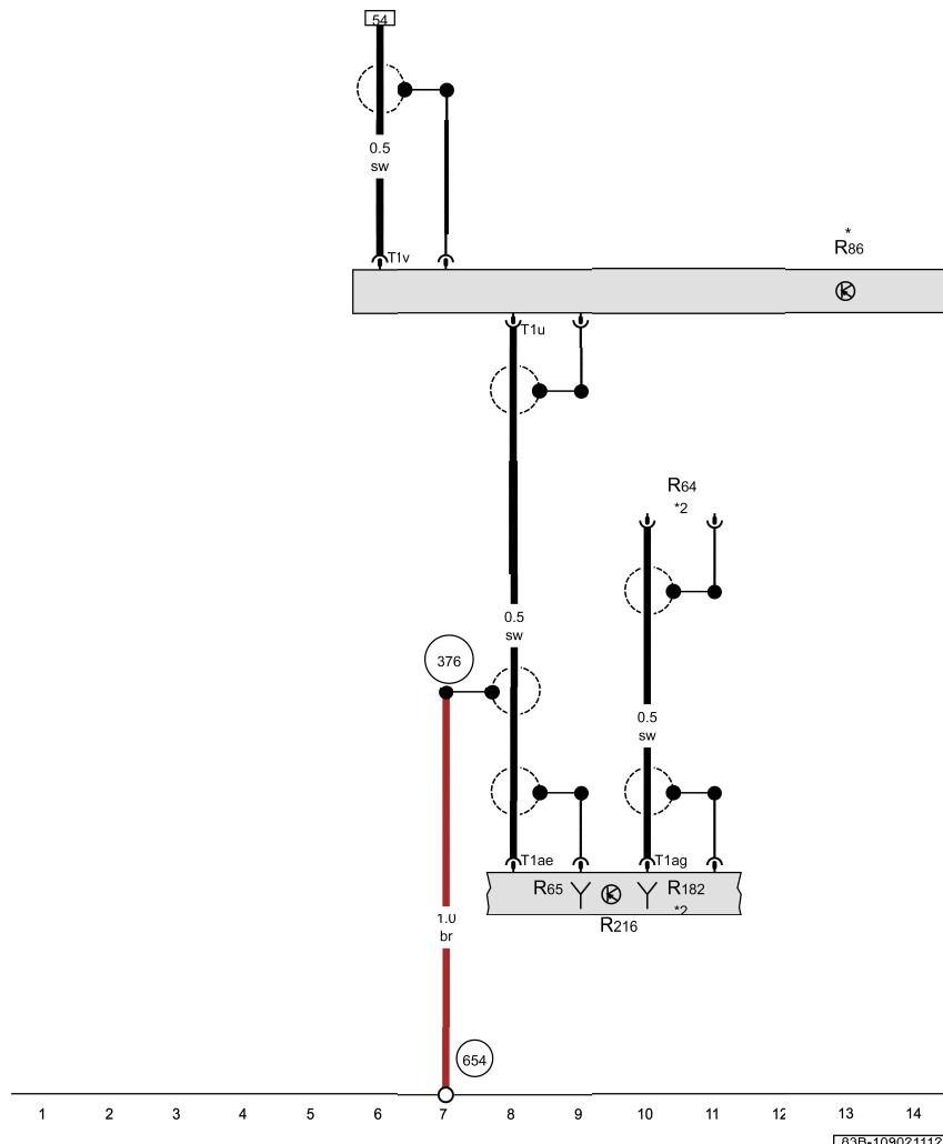
驻车暖风无线电接收器, 电话天线, 移动电话功率放大器, 辅助暖风装置天线, 车顶天线
